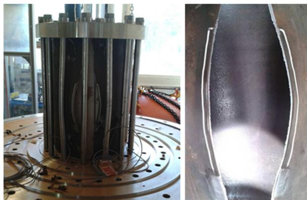
**Fig. 1 :** Essai destructif sur tronçon DN 300 pré-entaillé.
